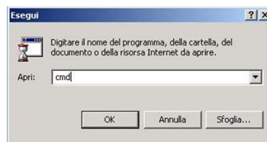
Figura 8: avvio di una console di Dos.
